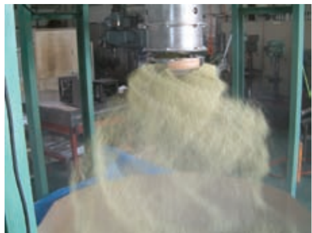
触媒充填マシンによる触媒充填のデモ
