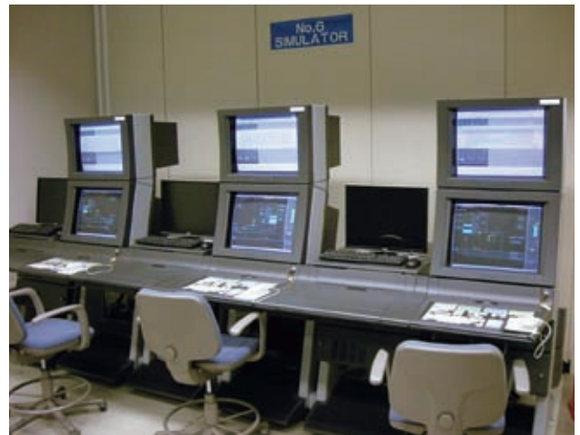
旧訓練シミュレーター（2001 年更新、DCS; 山武製 Advanced-PS R530）
