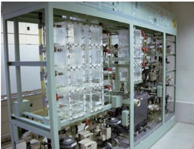
旧訓練シミュレーター（2001 年更新、DCS; 山武製 Advanced-PS R530）
