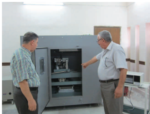
日本から送られ、PRDC内に設置された、ホイールトラッキング装置。 左は、当事業のイラク側リーダー：マーハー・B・アントゥワン氏 （PRDC シニア・チーフ・エンジニア）
